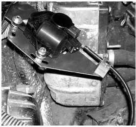
Рисунок 2 – Установка устройства в моторном отсеке и подключение тросика привода
