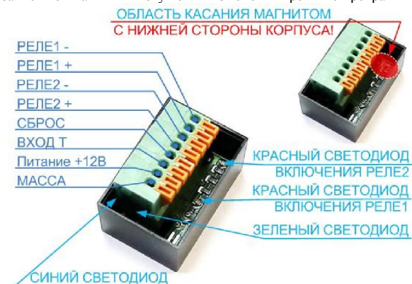
Рисунок 1 – Внешний вид программируемого таймера «СИЛИЧЬ-КРОНОС-Т» с обозначением расположения контактов, элементов индикации и управления
