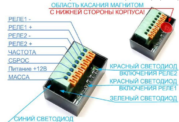
Рисунок 1 – Внешний вид управляемого частотой программируемого таймера «СИЛИЧЬ-КРОНОС-V» с обозначением расположения контактов, элементов индикации и управления
