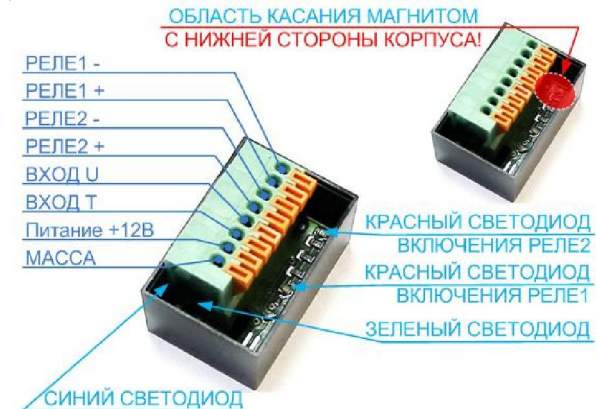
Рисунок 1 – Внешний таймера управления свечами накала «СИЛИЧЬ-КРОНОС-TNS» с обозначением расположения контактов, элементов индикации и управления
