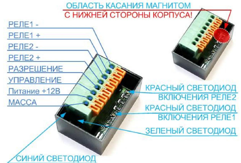
Рисунок 1 – Внешний вид программируемого таймера «СИЛИЧЬ-КРОНОС-ROS» с обозначением расположения контактов и элементов индикации и управления
