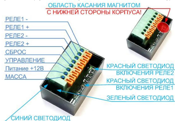
Рисунок 1 – Внешний вид программируемого двухканального таймера «СИЛИЧЬ-КРОНОС-ROF» с обозначением расположения контактов и элементов индикации и управления
