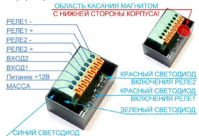
Рисунок 1 – Внешний вид программируемого таймера «СИЛИЧЬ-КРОНОС-OIS» с обозначением расположения контактов, элементов индикации и управления
