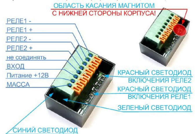
Рисунок 2 – Внешний вид программируемого таймера «СИЛИЧЬ-КРОНОС-KLC» с обозначением расположения контактов, элементов индикации и управления
