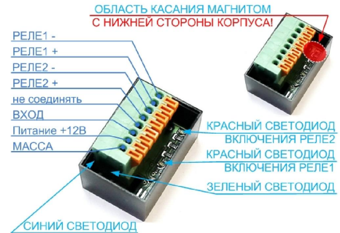
Рисунок 1 – Внешний вид программируемого таймера «СИЛИЧЬ-КРОНОС-ДТС» с обозначением расположения контактов и элементов индикации и управления
