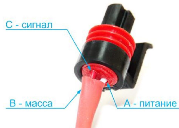
Рисунок Б.2 Вид разъема датчика загрузки сзади.
