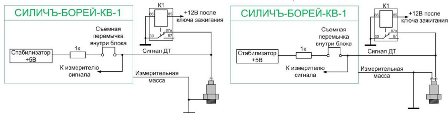
Рисунок Б.1 – Схема подключения дополнительного ДТ
