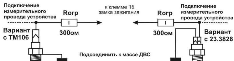
Рисунок Б.1 – Схема подключения дополнительного ДТ
