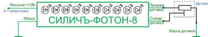
Рисунок 2 – Схема подключения светодиодной шкалы «СИЛИЧЬ-ФОТОН-8»
