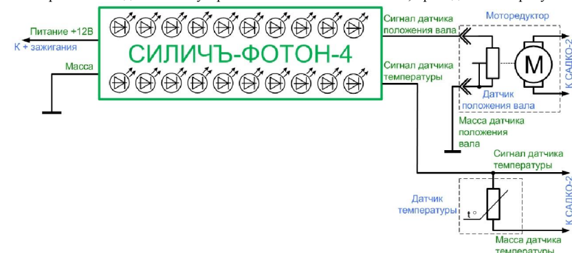
Рисунок 3 – Схема подключения двояной светодиодной шкалы «СИЛИЧЬ-ФОТОН-4».
