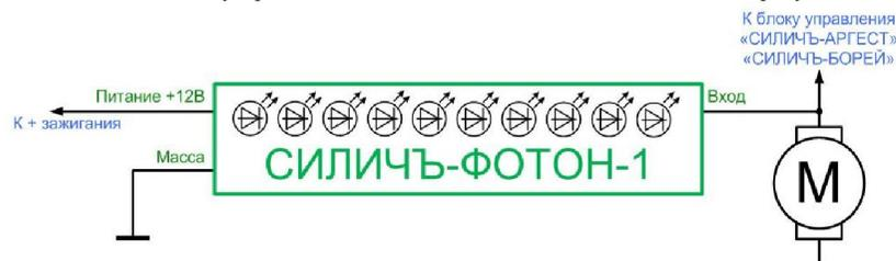
Рисунок 2 – Схема подключения индикационной светодиодной шкалы «СИЛИЧЬ-ФОТОН-1»
