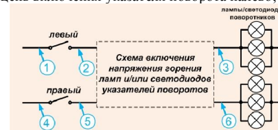
Рисунок 2 – Общая схема управления указателями поворотов.
