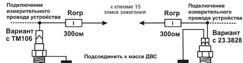
Рисунок В.1 – Схема подключения дополнительного ДТ
