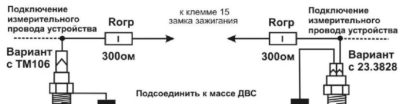
Рисунок Б.1 – Схема подключения дополнительного ДТ
