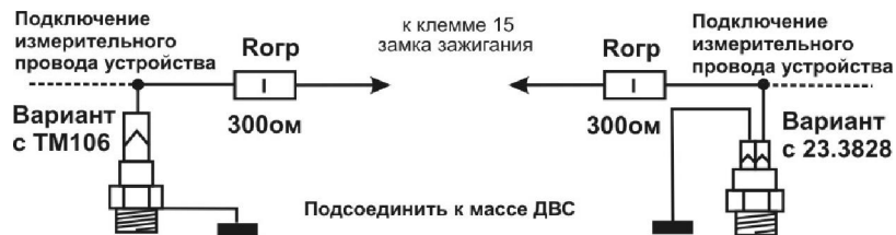
Рисунок Б.1 – Схема подключения дополнительного ДТ
