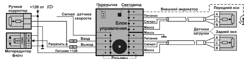
Рисунок 1 – Типовая схема подключения автоматического корректора света фар
